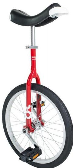
Le monocycle est un véhicule qui touche le sol avec une seule roue. Le modèle le plus courant se compose d'un pédalier, sans chaîne et dont les manivelles directement fixées sur l'axe de la roue, et d'une selle, plus longue et plus étroite à l'avant qu'à l'arrière afin de permettre un meilleur maintien. On la voit courbée ce qui permet de garder plus l'équilibre, on peut donc se permettre de rouler avec une roue. Mais il y a aussi des risques de chutes assez élevés.
