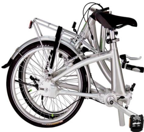
Un vélo pliant ou vélo pliable, est un vélo dont le cadre et d'autres parties se plient à l'aide de charnières qui se verrouillent. Les parties pliées restent ainsi solidaires. Il se distingue du vélo démontable (ou séparable) tel que celui conçu par Alex Moulton. Le vélo pliant (ou séparable) a été créé en 1878 par William Grout puis amélioré en 1979 par DAVID Hon (la marque Dahon).
